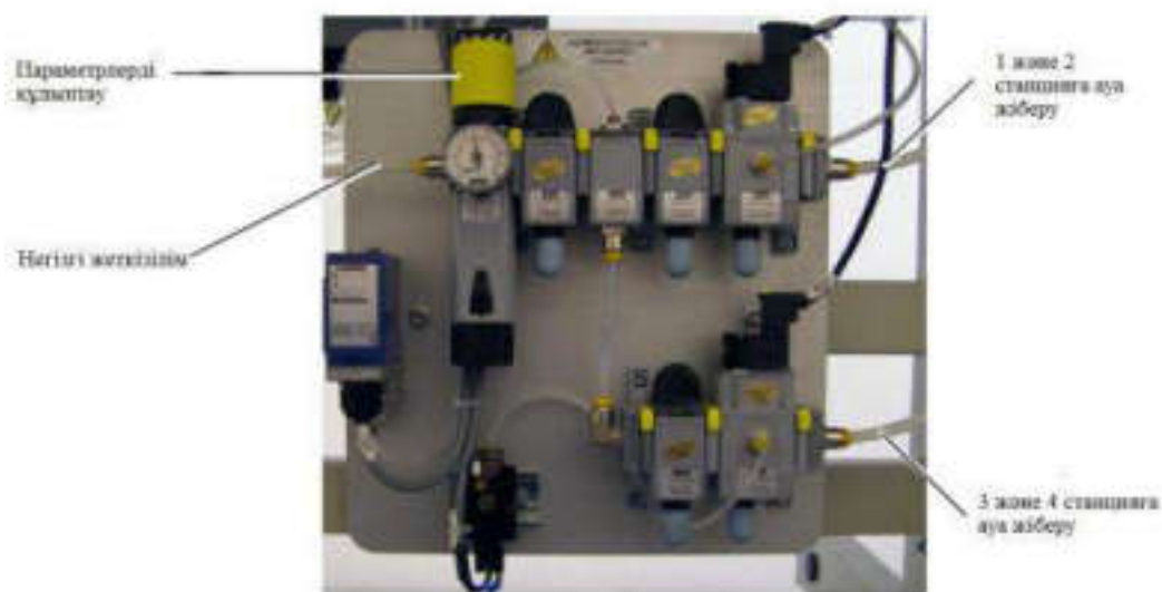
2 сурет - Сығылған ауа дайындау жүйесі
