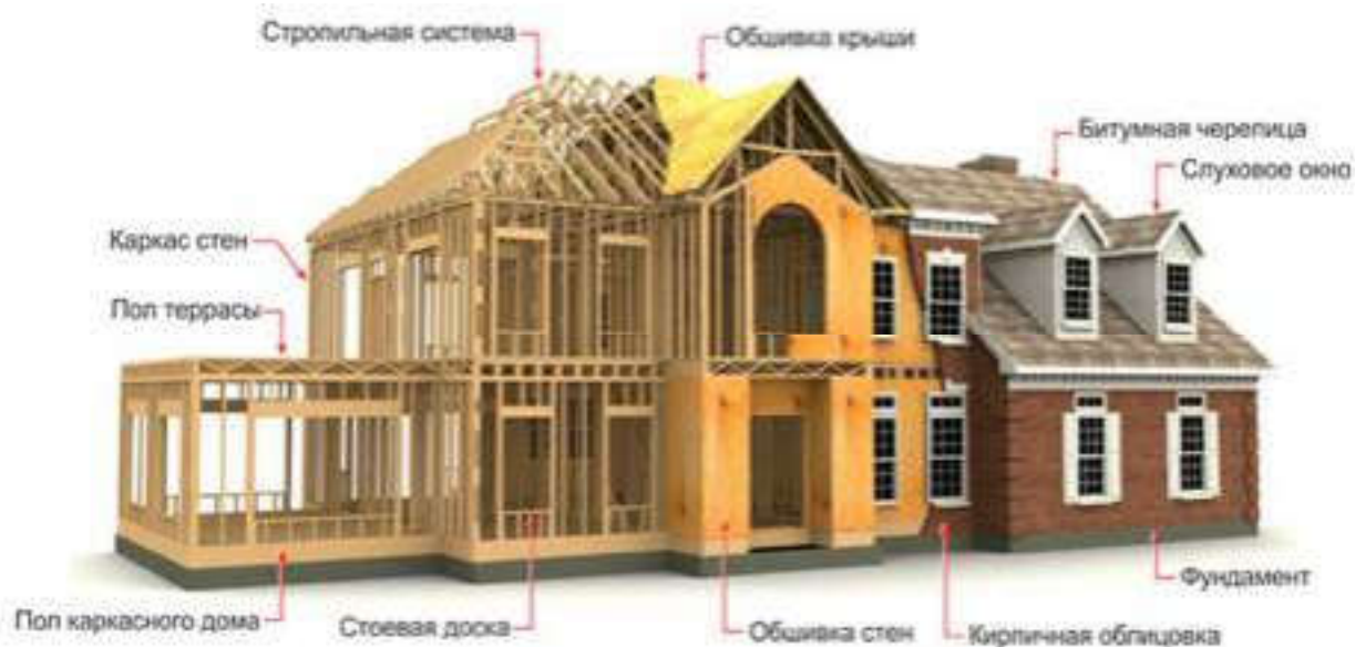
Рисунок 3 - Канадская деревянно-каркасная технология строительства домов.
