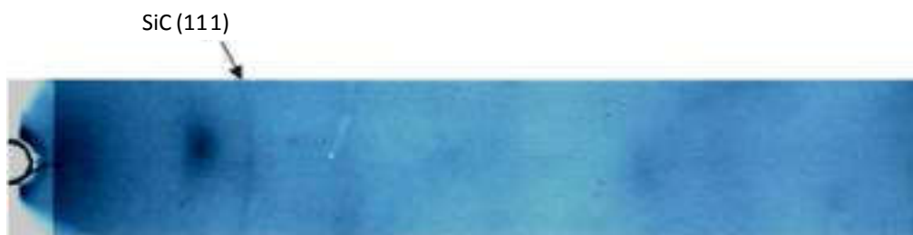
Рисунок 3 – Дебаеграмма тонкой пленки SiC, полученной методом магнетронного распыления после отжига при температуре 1100°C в течение 30 мин в атмосфере аргона
